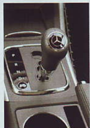
Seitliches Antippen macht die stufenlose Automatik zum Siebengang-Getriebe
