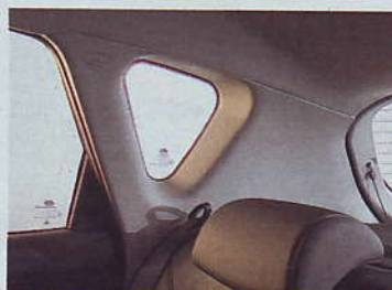
Aus 1,4 Liter Hubraum schöpft der Einstiegsmotor 109 PS. Trotz Dreieckfenster ist die breite C-Säule für die Sicht nach hinten eher hinderlich. Die Sitze für Fahrer und Beifahrer überzeugen mit guter Seitenführung
